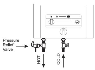
Fig. 4 - Pressure Relief Valve
